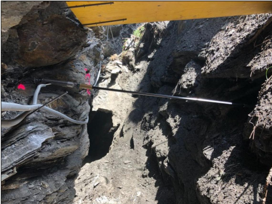
**Abbildung 8:** eingebauter Extensometer S3
